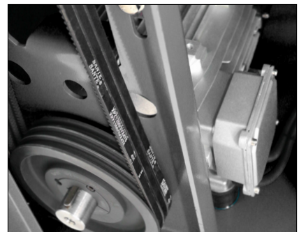
Transmission poulie-courroie et moteur électrique IE3
