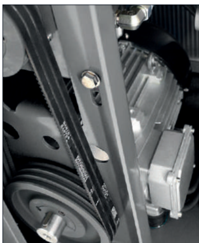
Transmission poulies-courroies et moteur électrique IE3
