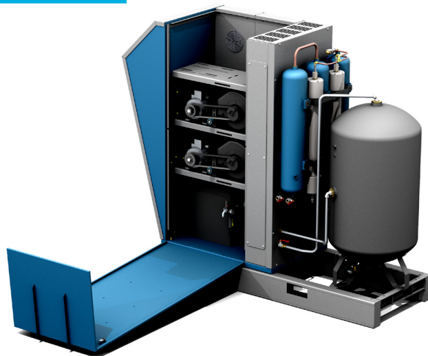
CONFIGURATION DEUX BLOCS + DEUX MEMBRANES AZOTE
